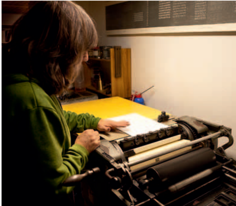
Pressen: So wurden in Zeiten, wo Zeilen aus beweglichen Bleileetern mit Handkraft auf Papier gepresst wurden, die Druckhäuser genannt. Michael Karner hält dieses Handwerk an seiner FAG-Andruckpresse von ca. 1960 hoch. Daneben stehen noch eine Kniehebelpresse (1880) und ein Handtiegel (1920).
